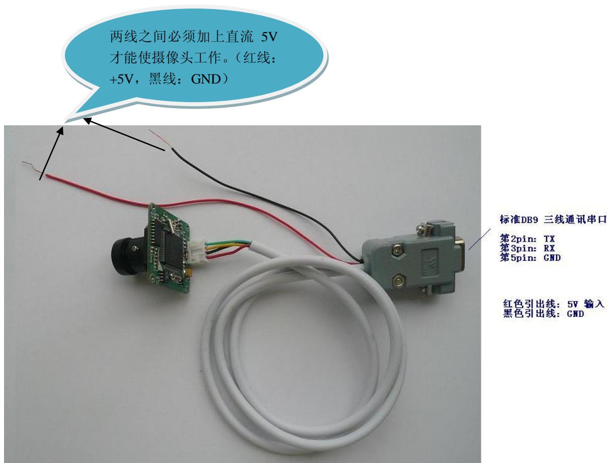
PTC08 模块板+延长线 完整视图
